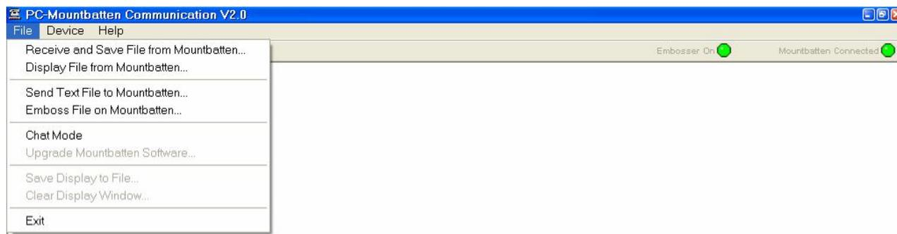
MB COMM обеспечивает лёгкую передачу информации между MB W+ и компьютером. Помните, что файлы, которые вы отправляете на машинку, должны быть переведены перед тиснением, поэтому, пожалуйста, прочитайте следующие Главы о переводе Брайля.
