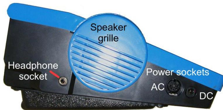
Рисунок 6: Левая сторона машинки MB W+ с разъемами и решеткой динамика
