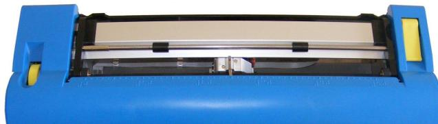
Рисунок 3: Машинка MB W+ с установленной прижимной планкой.
