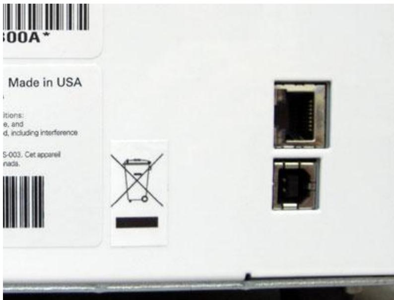
*Демонстрация USB и LAN портов на обратной стороне тиснителя*
