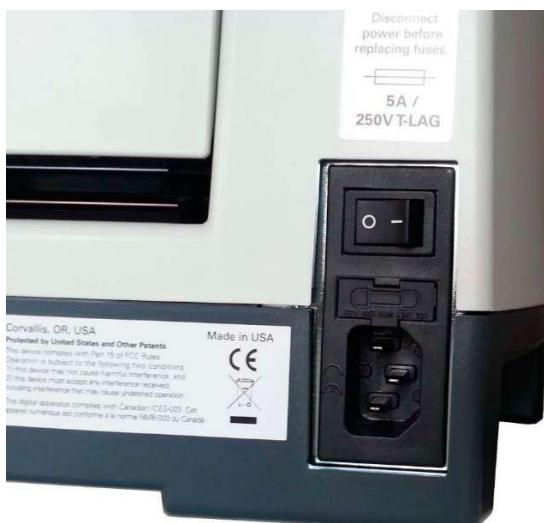
*Изображение силового модуля на задней стороне принтера*
