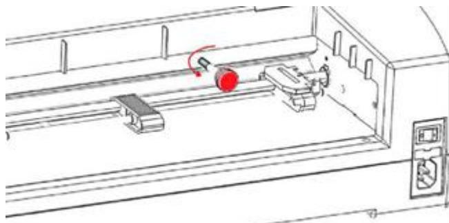
Изображение винта с накатанной головкой для блокировки каретки во время транспортировки
