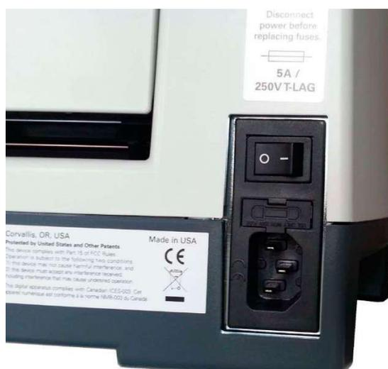
*Изображение силового модуля на задней стороне принтера*
