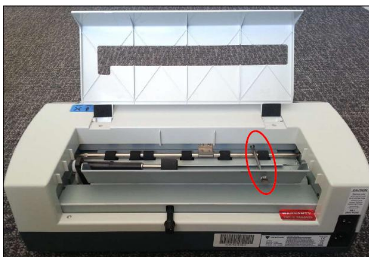
Изображение винта с накатанной головкой для блокировки каретки во время транспортировки
