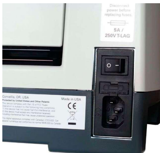
Изображение силового модуля на задней стороне принтера
