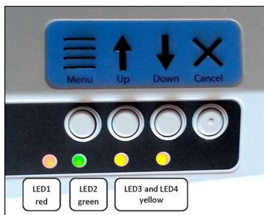
Изображение панели управления оператора со светодиодными индикаторами
