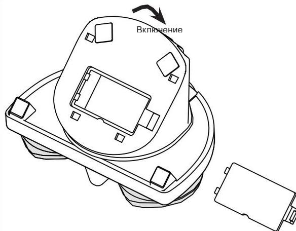
Подключите одну 9-вольтовую батарею в нижней части устройства. Поверните ручку регулировки громкости, чтобы включить устройство.
