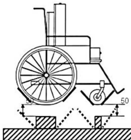
б) метод испытания на прочность при падении «типа люльки» (ноги манекена не показаны для простоты)
