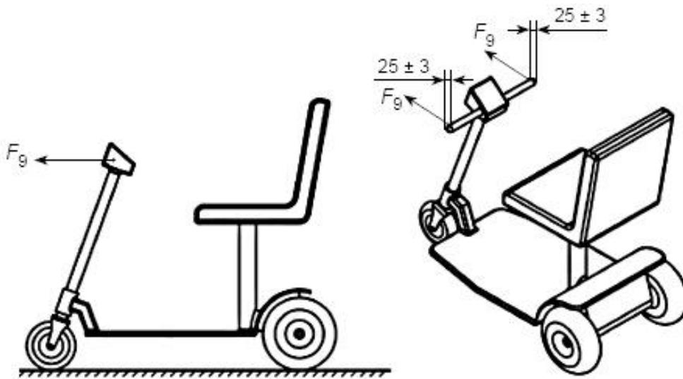
Рисунок 19 - Силы, прикладываемые к рукояткам управления скутером
