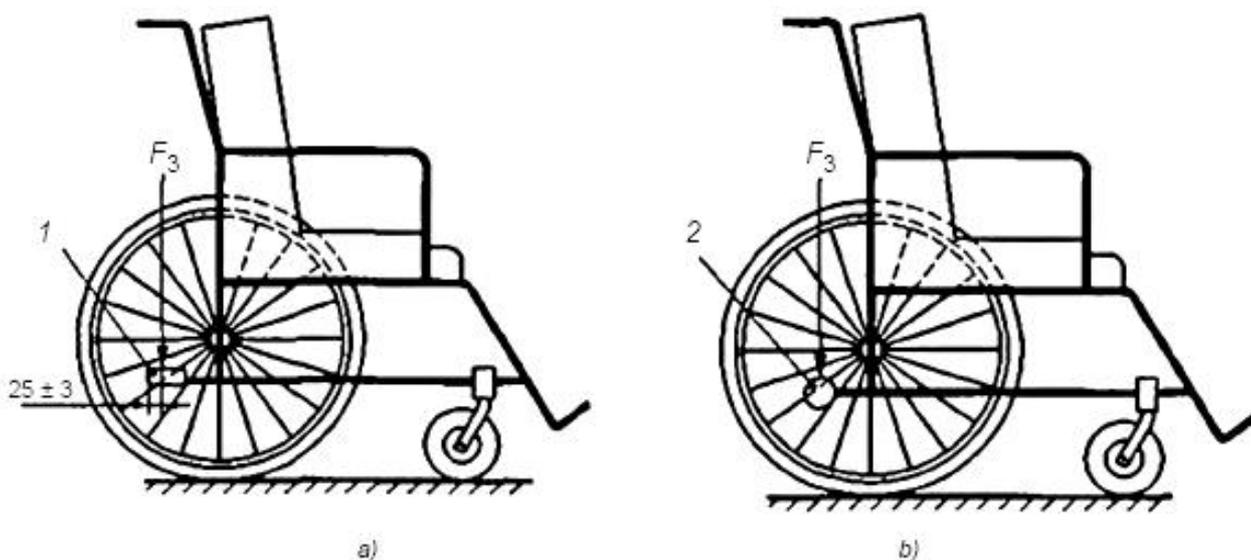
1 - рычаг наклона; 2 - часть, которая может использоваться для наклона кресла-коляски (пример: противоопрокидывающее устройство)
