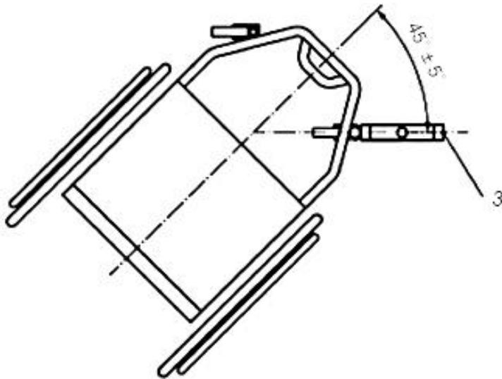
1 - угол отклонения; 2 - центр удара; 3 - маятник для испытания на ударную прочность самоориентирующегося колеса и опоры стопы
