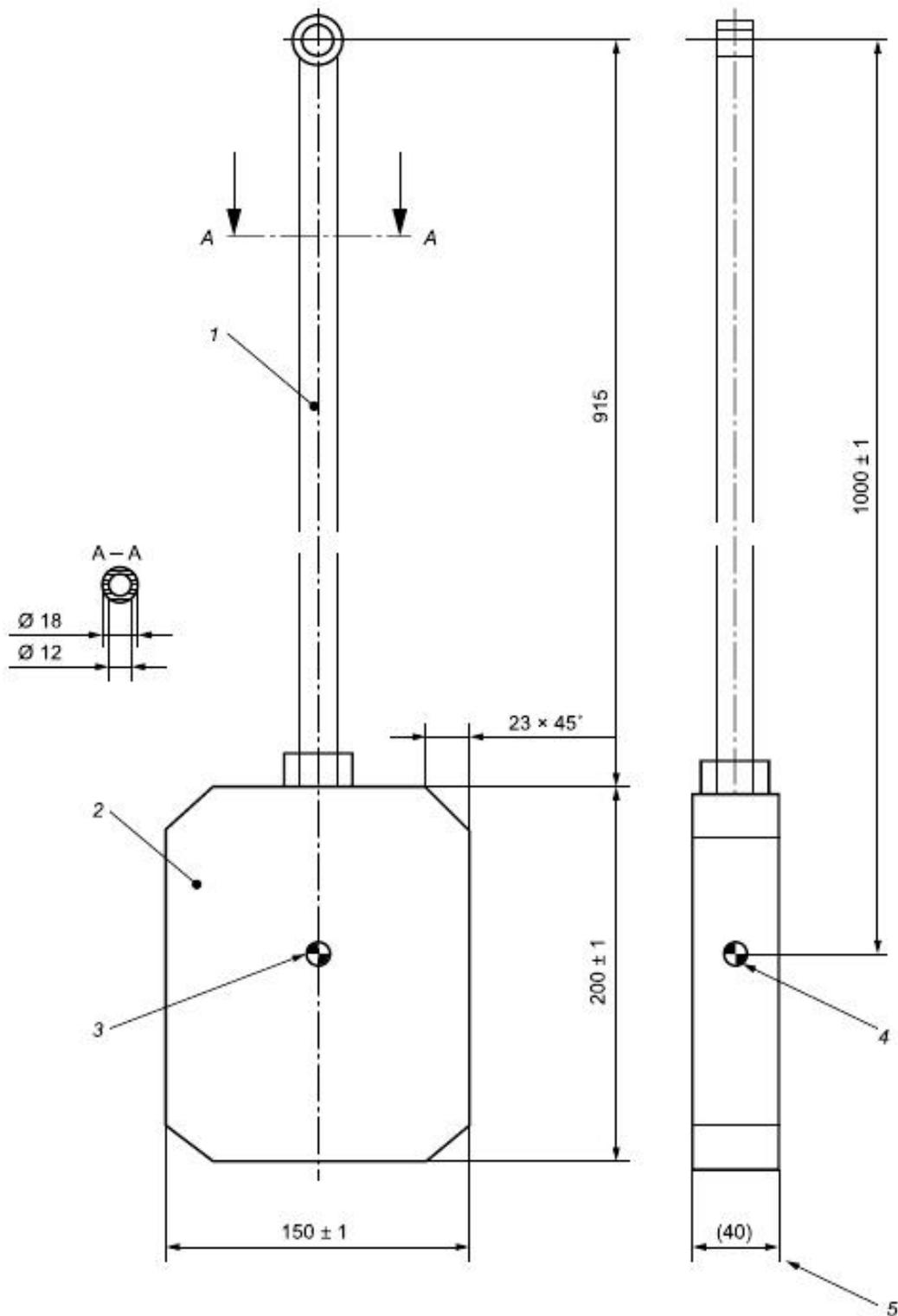
1 - стальная трубка; 2 - стальной блок; 3 - центр удара на плоской грани (вид спереди); 4 - центр удара боковой грани (вид сбоку); 5 - регулировка исходного размера, чтобы дать  $\pm 2\%$  от общей массы
