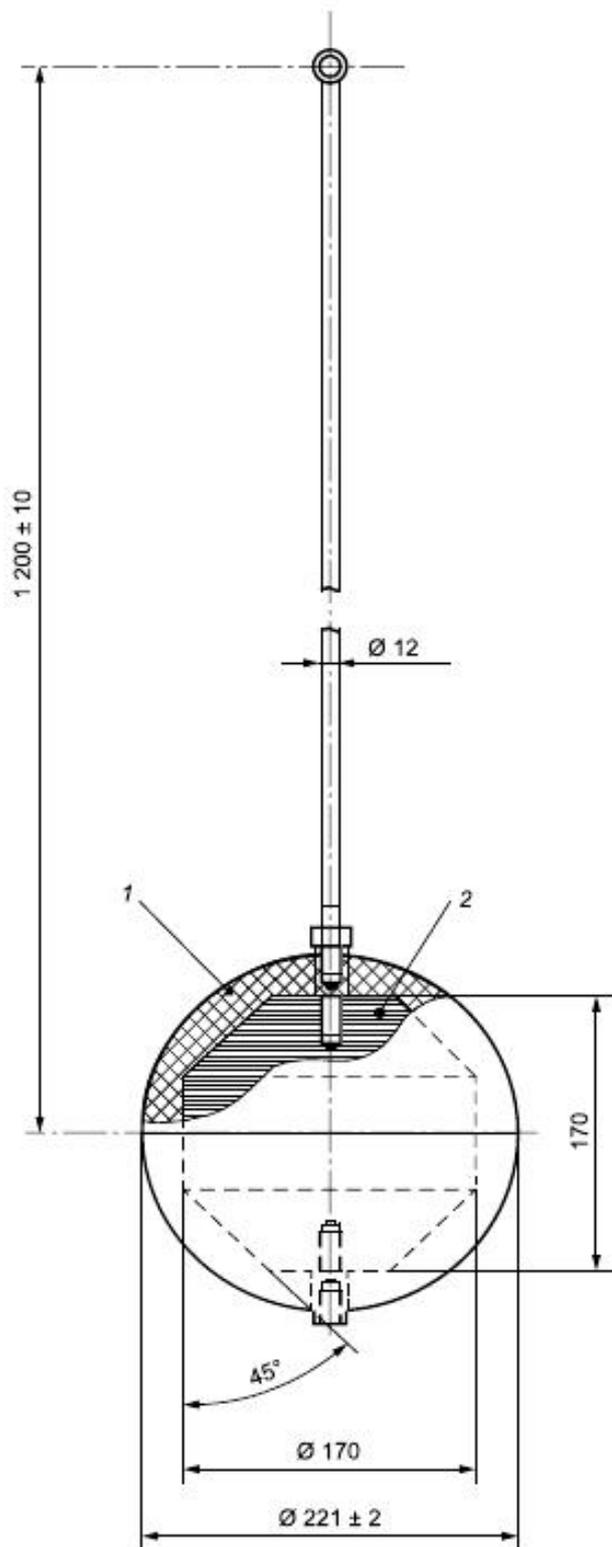
1 - полиуретановая сфера со следующими характеристиками: плотность 1150 кг/м<sup>3</sup>; твердость 80 единиц по Шору?А; эластичность 20%; 2 - сталь
