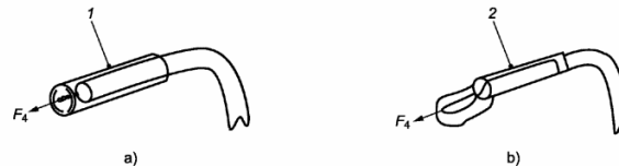
1 — трубка, прикрепленная к основе ручки клейкой лентой; 2 — тканная полоса, прикрепленная к основе ручки клейкой лентой и удерживаемая на месте шнурком до клейкого сращения
