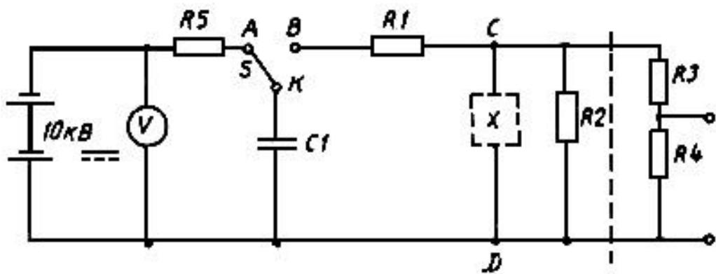
$C_1 = 1 \text{ мФ}$ ;  $R_1 = 1 \text{ кОм}$ ;  $R_2 = 4 \text{ кОм}$ ;  $R_3 = 100 \text{ МОм}$ ;  $R_4 = 0,3 \text{ МОм}$ ;  $R_5 = 15 \text{ МОм}$
