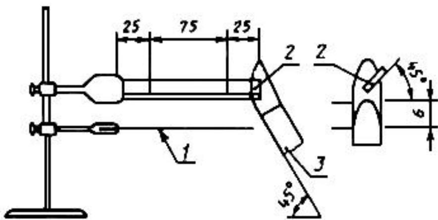
1 - металлическая (проволочная) сетка; 2 - образец; 3 - горелка
