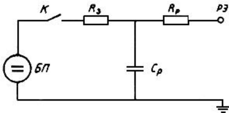
БП - блок питания;  $K$  - выключатель;  $R_з$  - заряжающий резистор, равный  $100 \text{ МОм} \pm 10\%$ ;  $C_p$  - конденсатор ЭСР =  $150 \text{ пФ} \pm 10\%$ . С предельно допустимым напряжением  $10 \text{ кВ}$ ;  $R_p$  - резистор разряда, равным  $150 \text{ Ом} \pm 5\%$ ;  $PЭ$  - разрядный электрод.
