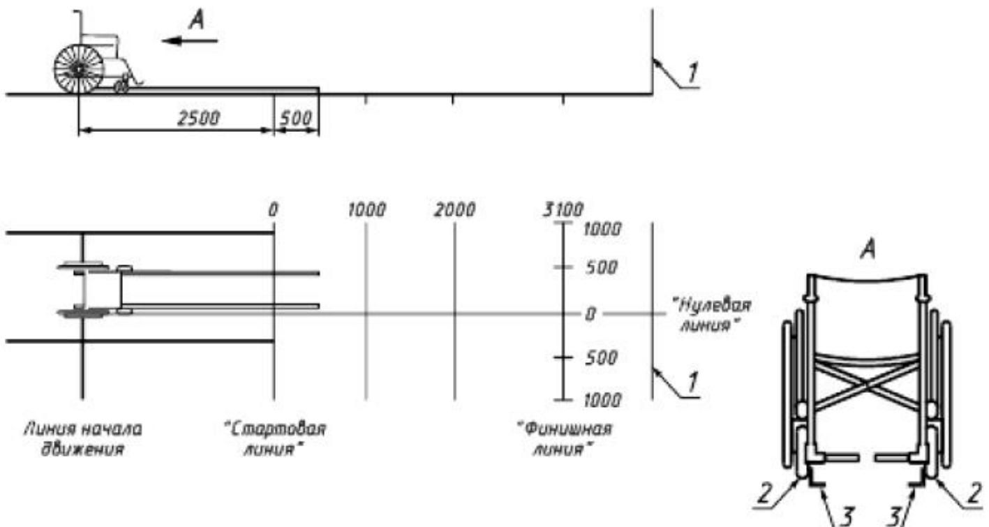
1 - предохранительная сетка; 2 - переднее колесо; 3 - направляющие рельсы
