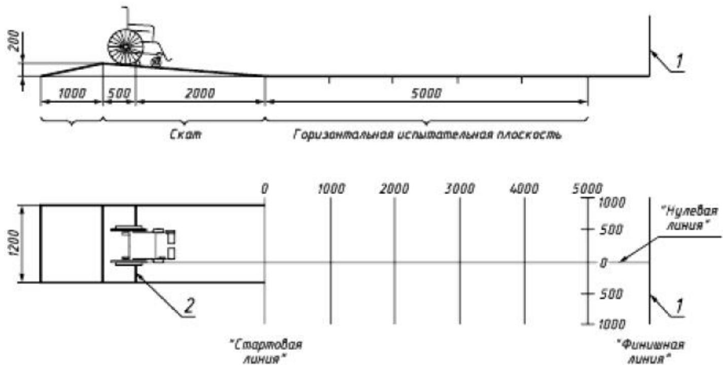
1 - предохранительная сетка; 2 - удерживающая система
