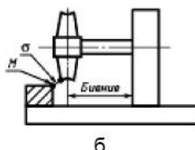
$M$  - вертикальное расстояние при положении колеса, которое соответствует среднему положению смещения;  $\delta$  - степень точности изготовления колеса в радиальном направлении;  $\vartheta$  - степень искривления колеса в осевом направлении
