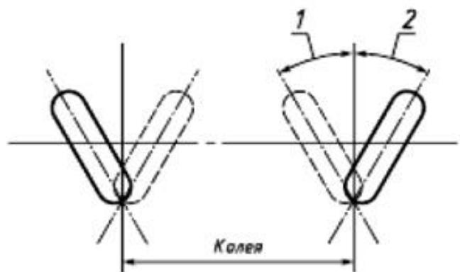
1 - отрицательный угол развала; 2 - положительный угол развала
