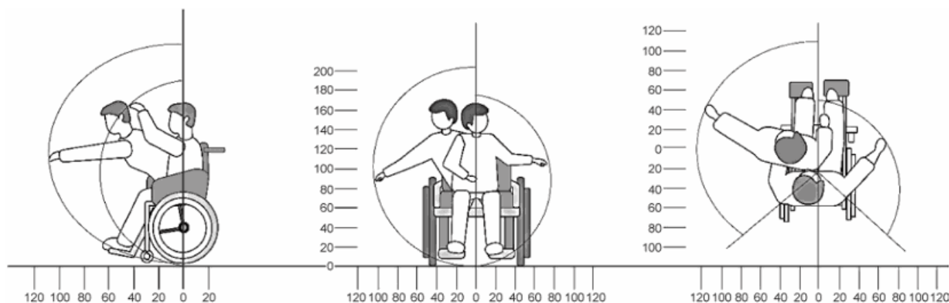
Рисунок А.1 - Зона досягаемости для инвалидов в кресле-коляске
