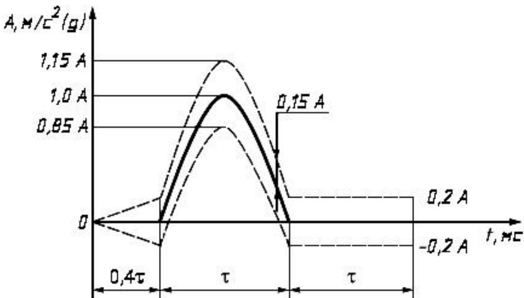
Рисунок А.1 - Полусинусоидальный импульс ударного воздействия
