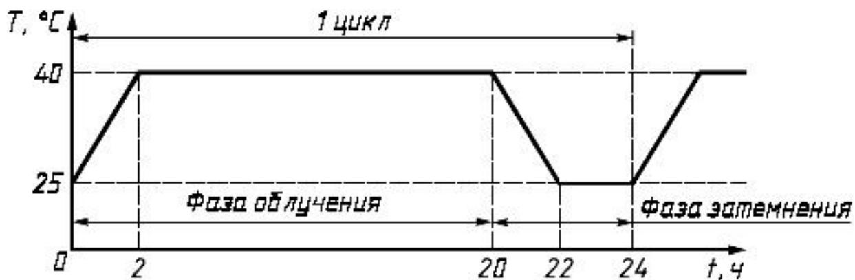
Рисунок 1 - График изменения температуры за один цикл испытаний
