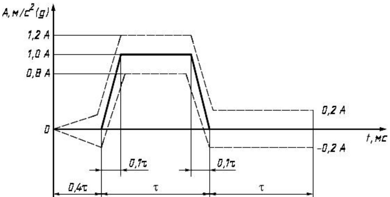
Рисунок А.3 - Трапецидальный импульс ударного воздействия
