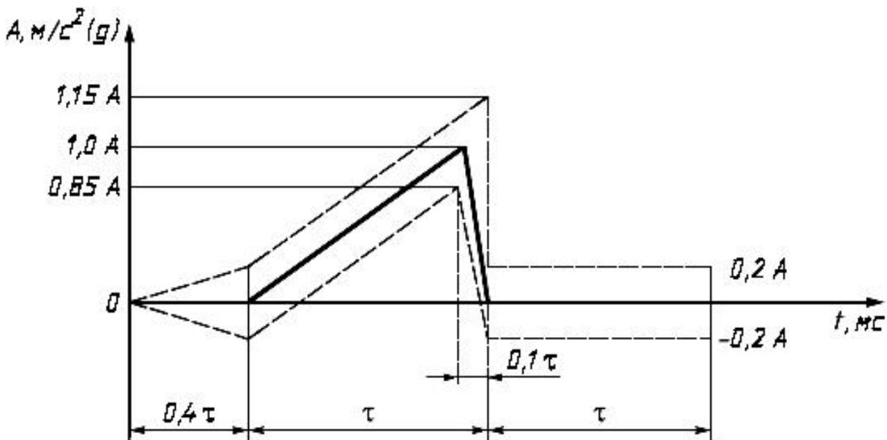
Рисунок А.2 - Треугольный (пилообразный) импульс ударного воздействия
