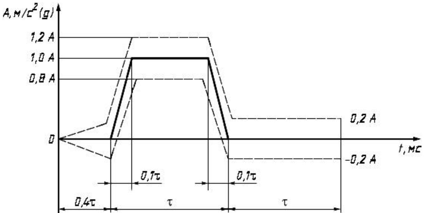
Рисунок А.3 - Трапецеидальный импульс ударного воздействия
