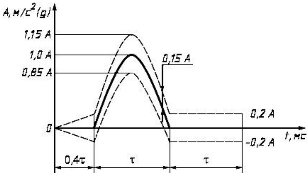
Рисунок А.1 - Полусинусоидальный импульс ударного воздействия
