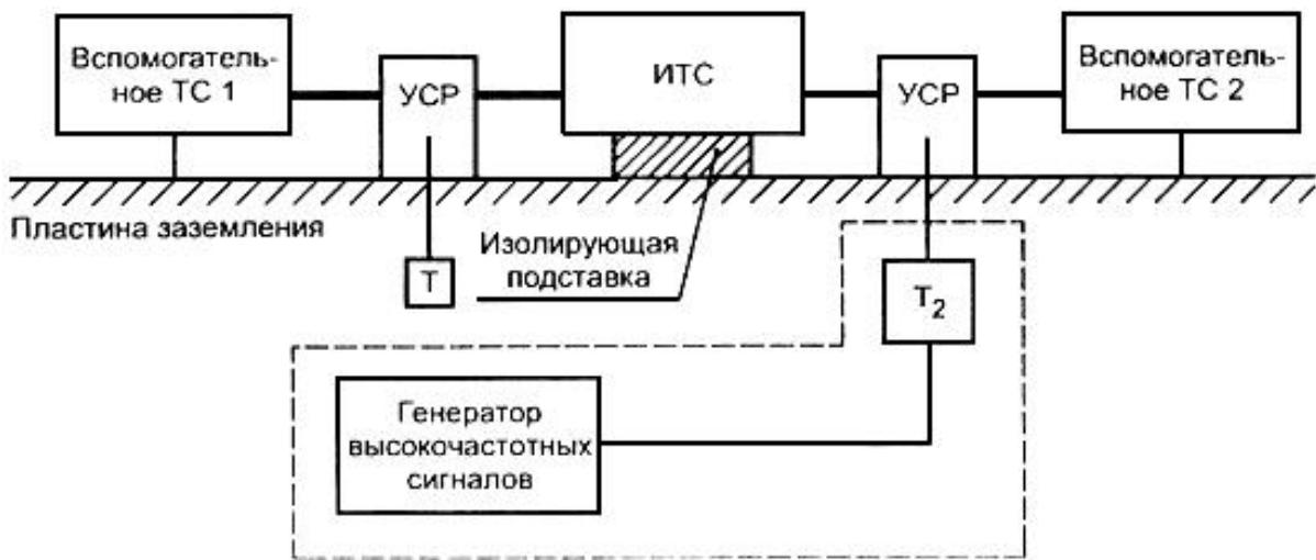
**T** - нагрузка 50 Ом; **T<sub>2</sub>** - аттенюатор (6 дБ)
