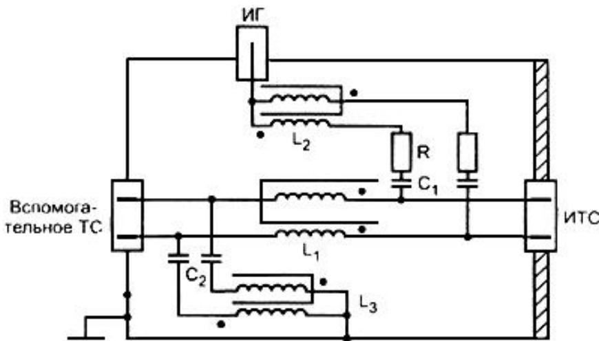
Примечание -  $C_1 = 10 \text{ нФ}$ ,  $C_2 = 47 \text{ нФ}$ ,  $R = 200 \text{ Ом}$ ,  $L_1 \geq 280 \text{ мкГн}$  на частоте  $150 \text{ кГц}$ ,  $L_1 = L_2 = 6 \text{ мГн}$  (когда  $C_2$  и  $L_2$  не используют, то  $L_1 \geq 30 \text{ мГн}$ )
