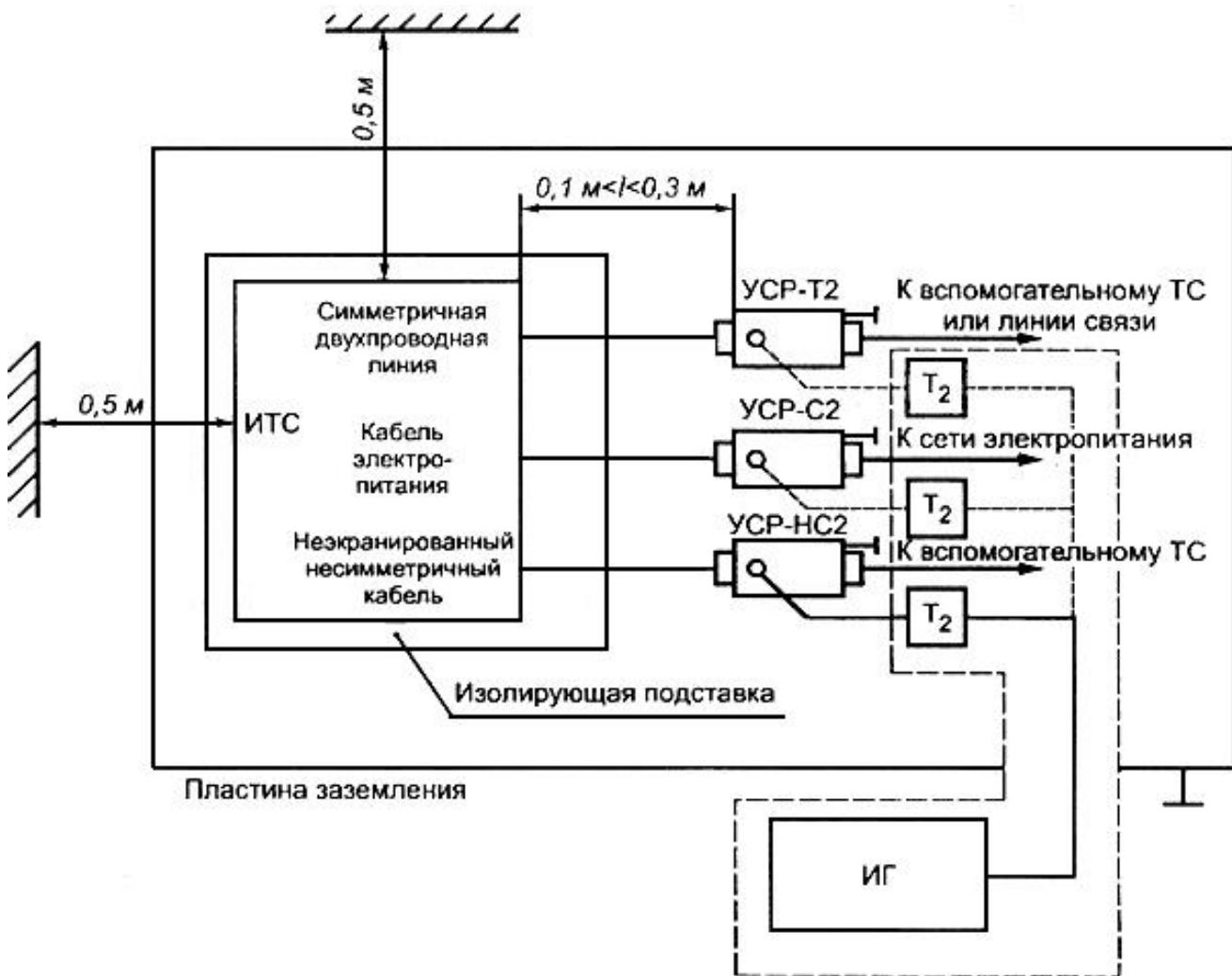
Примечания - Удаление ИТС от любых металлических предметов, исключая пластину заземления и устройства связи/развязки, должно составлять не менее 0,5 м. К разъемам "ИГ" устройств связи/развязки, на которые не подается сигнал от ИГ, подключают резисторы нагрузки сопротивлением 50 Ом
