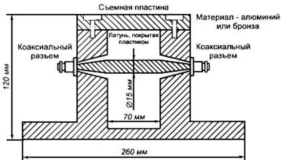
Рисунок А.2 - Конструкция испытательного блока сопротивлением 50 Ом
