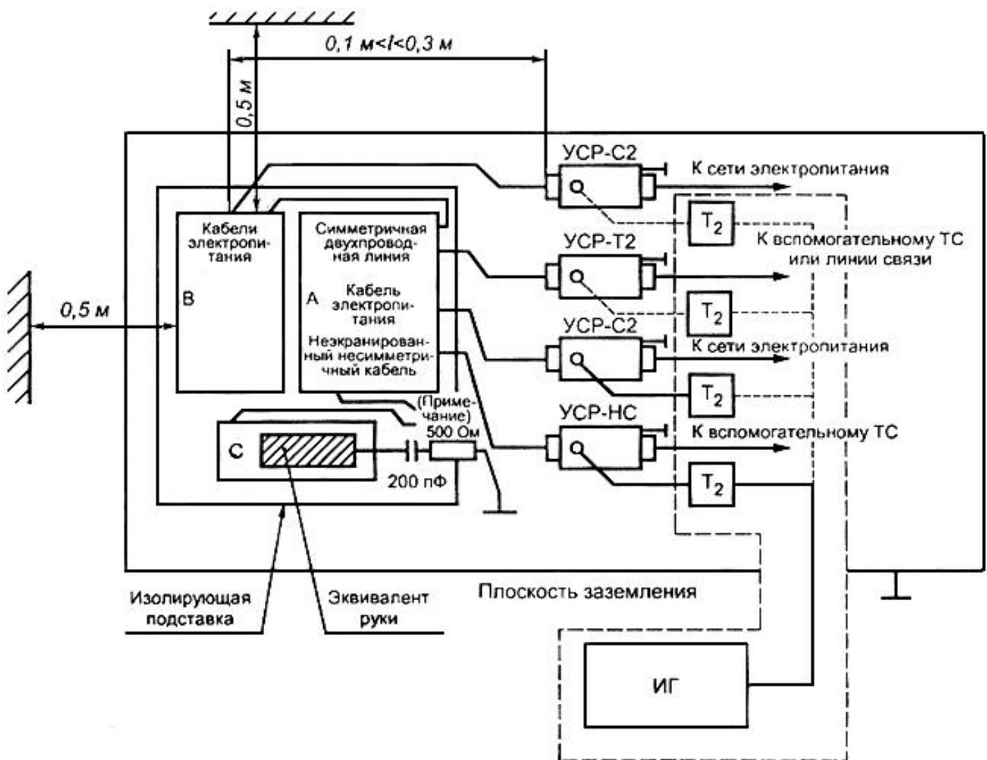
Примечания - Удаление ИТС от любых металлических предметов, исключая пластину заземления и устройства связи/развязки, должно составлять не менее 0,5 м. К разъемам "ИГ" устройств связи/развязки, на которые не подается сигнал от ИГ, подключают резисторы нагрузки сопротивлением 50 Ом. Кабели длиной не более 1 м, соединяющие блоки ИТС, укладывают на изоляционной подставке
