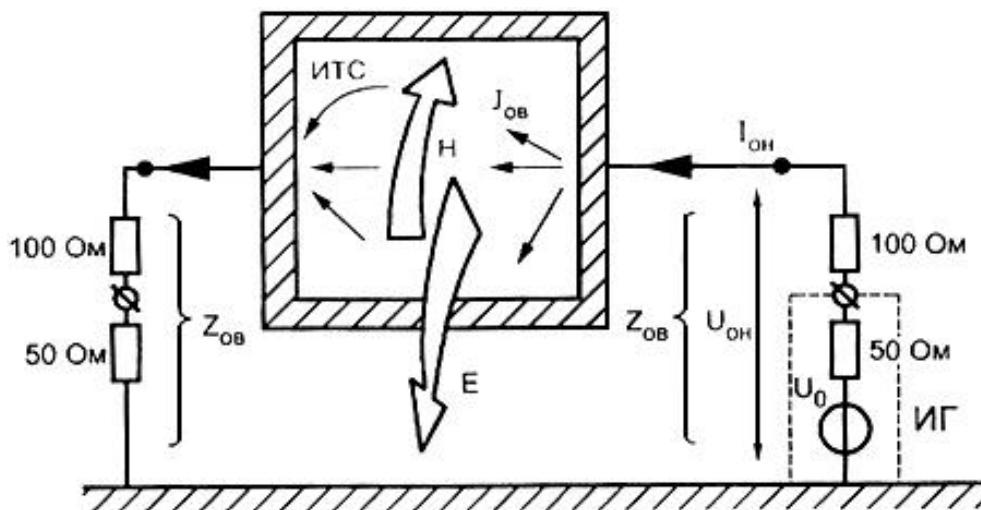
$Z_{OB}$  - полное сопротивление общего вида устройств связи/развязки, измеряемое в точке подключения ИТС;  $U_0$  - выходное напряжение ИГ в режиме холостого хода;  $U_{OH}$  - общее несимметричное напряжение между ИТС и пластиной заземления;  $I_{OH}$  - общий несимметричный ток, протекающий через ИТС;  $J_{OB}$  - токи на проводящих поверхностях и в проводниках ИТС;  $E$ ,  $H$  - электрические и магнитные поля
