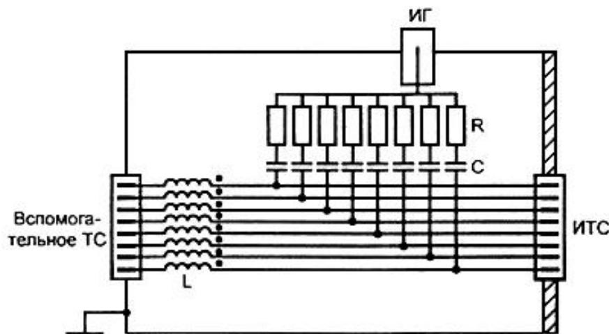
Примечание -  $C = 2,2 \text{ нФ}$ ,  $R = 800 \text{ Ом}$ ,  $L >> 280 \text{ мкГн}$  на частоте 150 кГц
