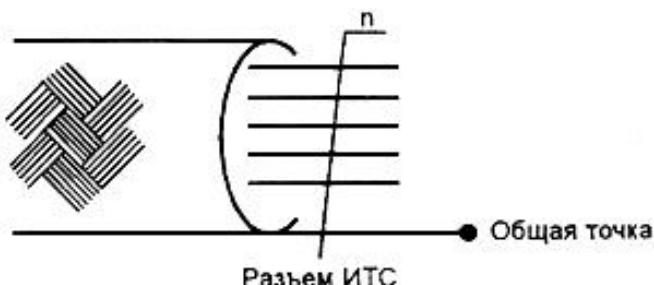
Рисунок 7б - Определение общей точки при использовании экранированных кабелей
