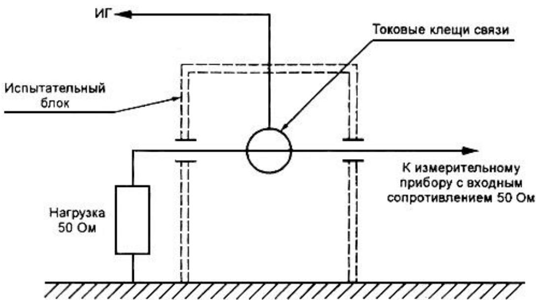
Рисунок А.1 - Схема установки уровня помехи с применением испытательного блока сопротивлением 50 Ом
