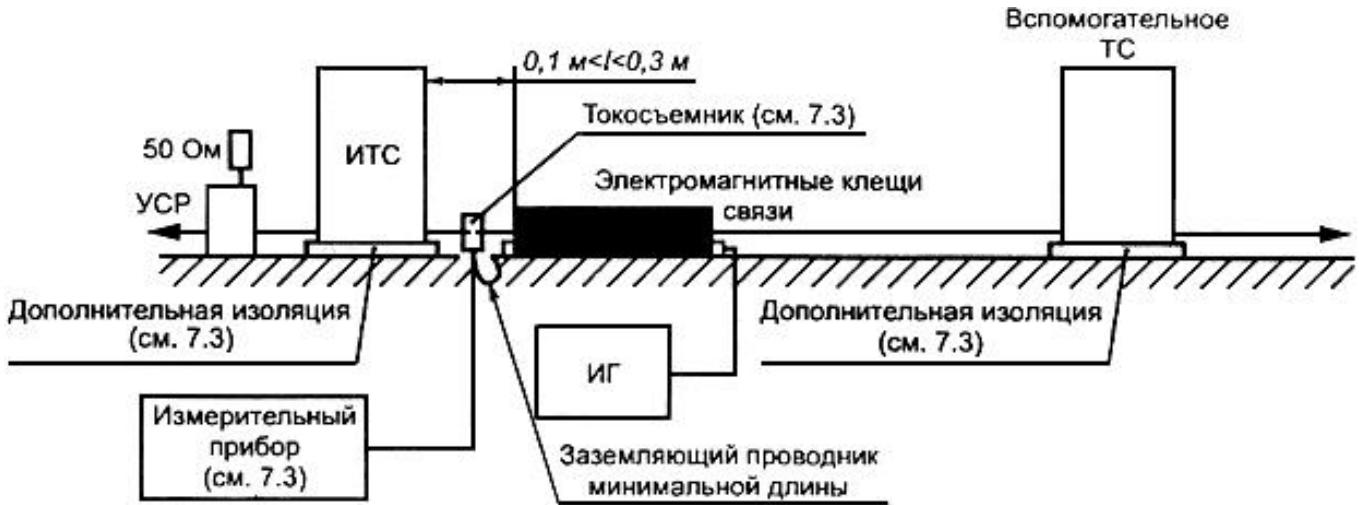
Рисунок А.3 - Общая схема рабочего места для испытаний с использованием клемм связь
