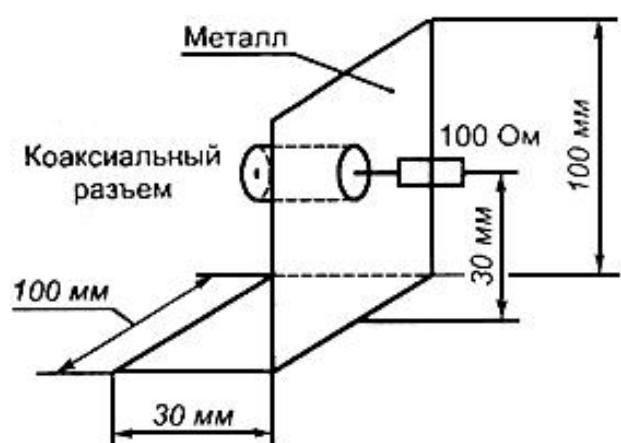
Примечание - Конструкция переходного устройства идентична конструкции стандартной пластины связи на рисунке ба. Добавлен резистор 100 Ом
