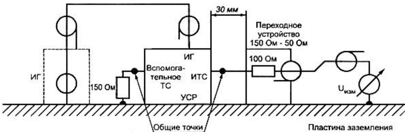
Примечание - Нагрузку 150 Ом на зажимах "Вспомогательное ТС" устройства связи/развязки, например, согласующее переходное устройство 150 Ом-50 Ом с дополнительным резистором 50 Ом, применяют только в случае неэкранированных кабелей (экран экранированного кабеля соединен с пластиной заземления на стороне вспомогательного ТС)
