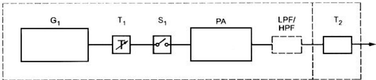
**G<sub>1</sub>** - генератор высокочастотных сигналов; **T<sub>1</sub>** - аттенюатор; **S<sub>1</sub>** - переключатель; **PA** - широкополосный усилитель мощности; **LPF/HPF** - фильтры низких и/или высоких частот; **T<sub>2</sub>** - аттенюатор с фиксированным затуханием (6 дБ)
