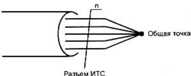
Рисунок 7а - Определение общей точки при использовании неэкранированных кабелей
