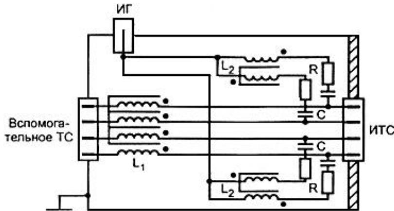
Примечание -  $C = 5,6 \text{ нФ}$ ,  $R = 400 \text{ Ом}$ ,  $L_1 \gg 280 \text{ мкГн}$  на частоте  $150 \text{ кГц}$ ,  $L_2 = 6 \text{ мГн}$
