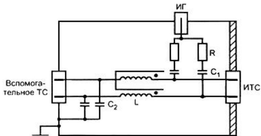
Примечание -  $C_1 = 10 \text{ нФ}$ ,  $C_2 = 47 \text{ нФ}$ ,  $R = 200 \text{ Ом}$ ,  $L \geq 280 \text{ мкГн}$  на частоте 150 кГц
