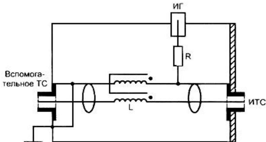
Примечание -  $R = 100 \text{ Ом}$ ,  $L \geq 280 \text{ мГн}$  на частоте 150 кГц
