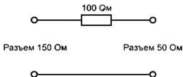
Примечание - Резистор на металлической пленочной основе,  $P \geq 2,5$  Вт
