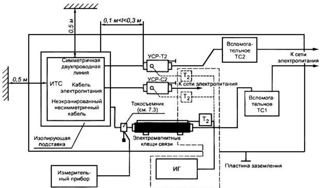
Примечание - Удаление ИТС от любых металлических предметов (исключая пластину заземления и устройства связи/развязки) должно составлять не менее 0,5 м. К разъемам устройств связи/развязки, на которые не подается сигнал от ИГ, подключают сопротивление 50 Ом
