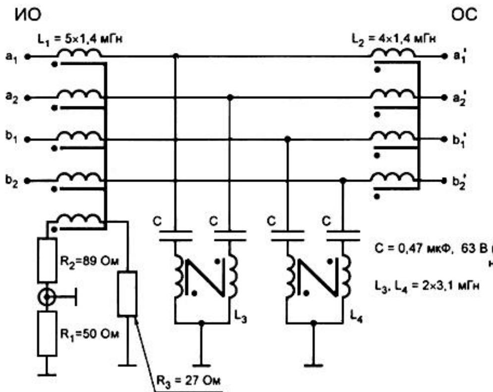
Рисунок В.2 - Эквивалент полного сопротивления сети с большим затуханием продольного перехода для применения с двумя неэкранированными симметричными парами
