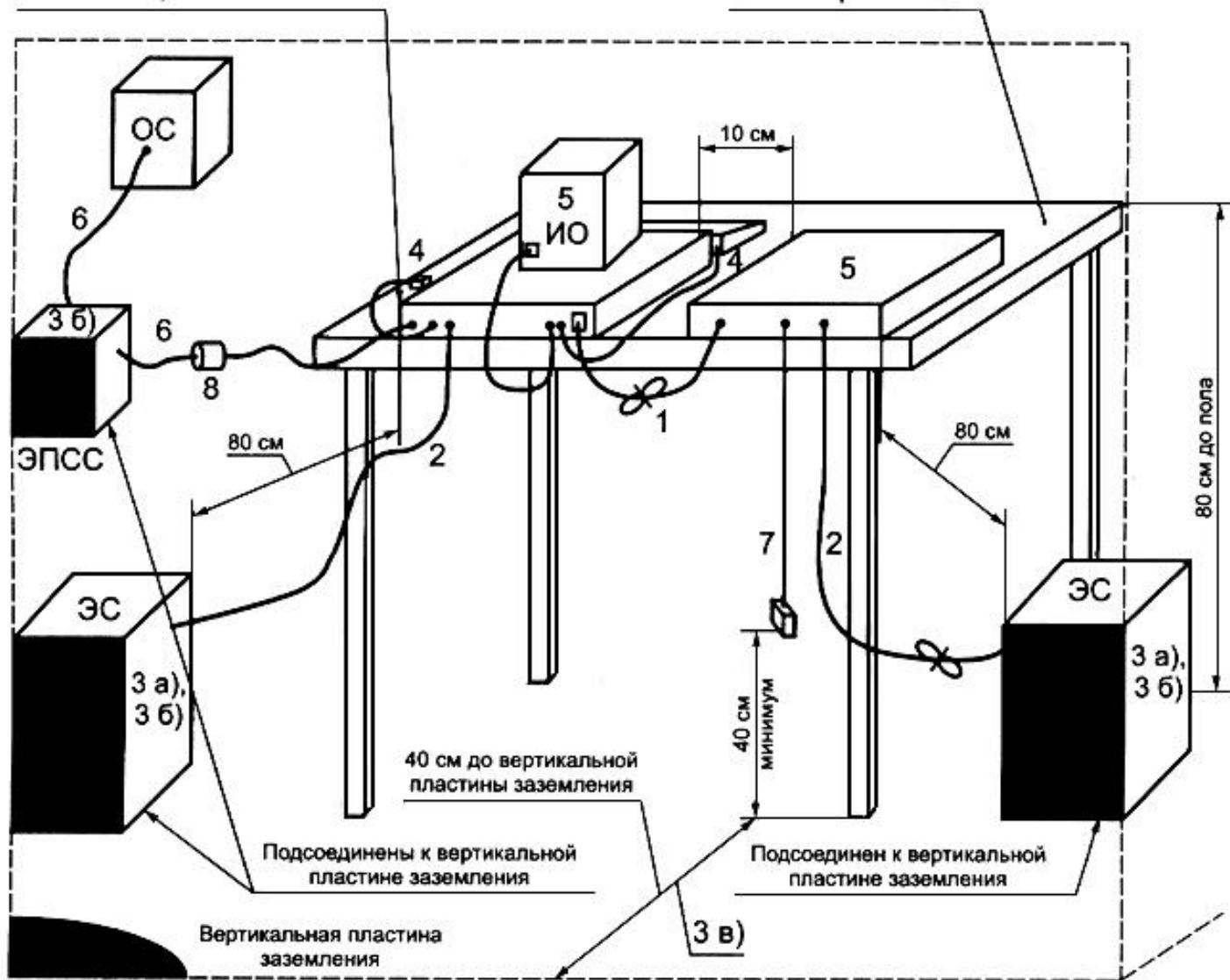
1 - кабели, которые висят на расстоянии менее 40 см от горизонтальной пластины заземления и не могут быть укорочены до подходящей длины, укладываются в связки длиной от 30 до 40 см;
