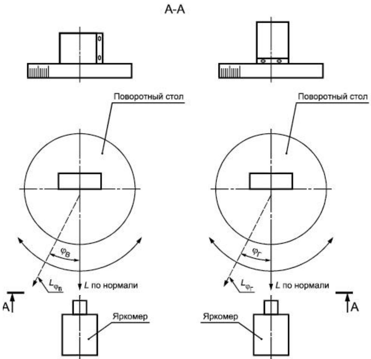
а) Поворот в вертикальной плоскости      б) Поворот в горизонтальной плоскости
