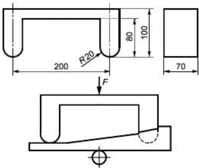
Рисунок Д.1 - Устройство для испытаний упора стопы
