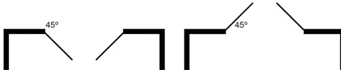
Рисунок 33 - Дверной проем с двустворчатыми дверными полотнами
