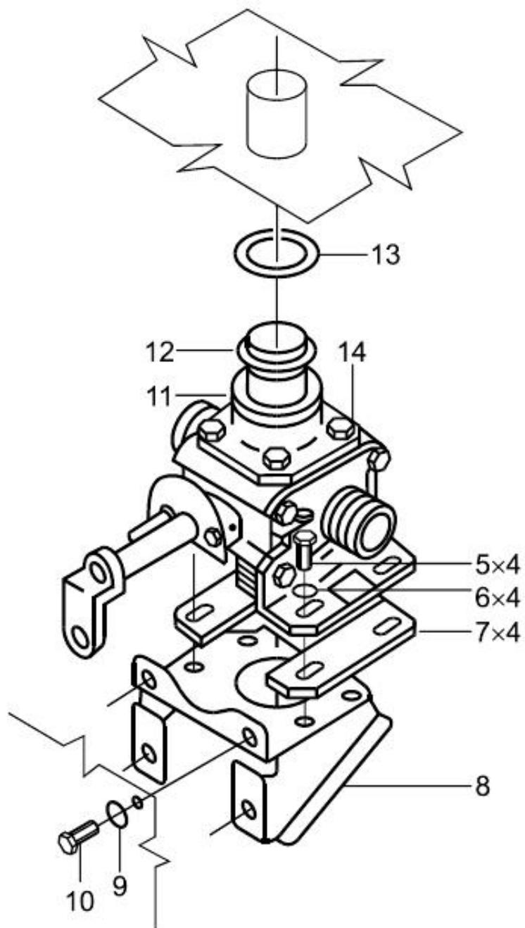
Рисунок В.1 - Пример указания количества одинаковых деталей
