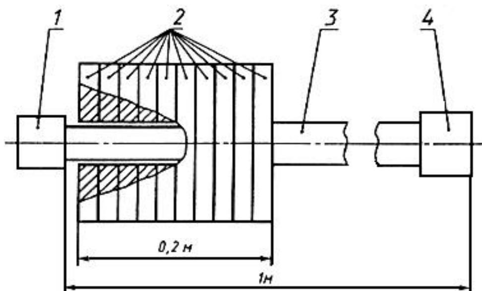
1 - разъем для подключения к испытываемому устройству; 2 - ферритовые кольца ( $\mu \approx 200 - 400$ );
