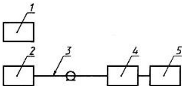
1 - генератор замещающих сигналов; 2 - испытываемый ВМ; 3 - коаксиальный кабель;
