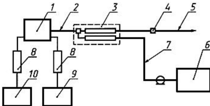
1 - испытуемое устройство; 2 - провод, в котором проводится измерение мощности радиопомех;
