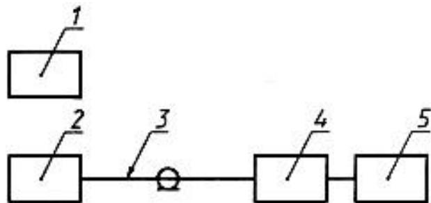
1 - генератор замещающих сигналов; 2 - испытуемый ВМ; 3 - коаксиальный кабель;
