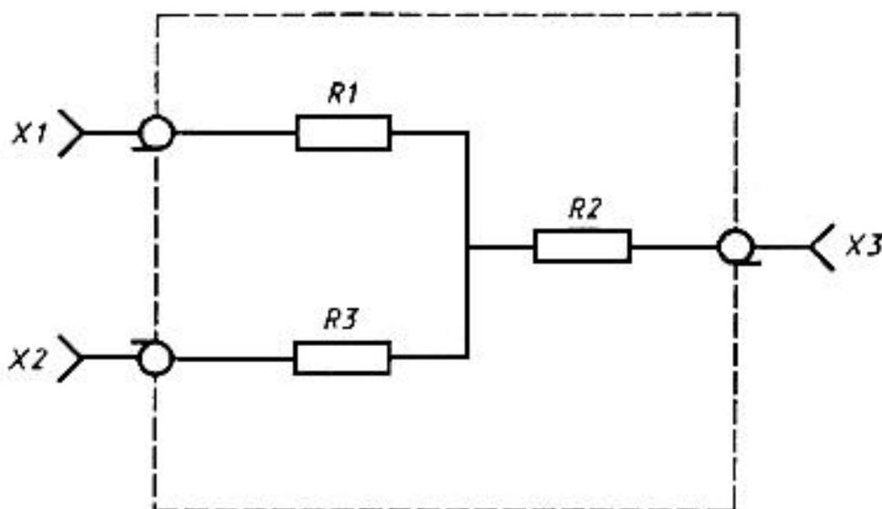
$X1$ ,  $X2$ ,  $X3$  - высокочастотный коаксиальный разъем с волновым сопротивлением 75 Ом;
