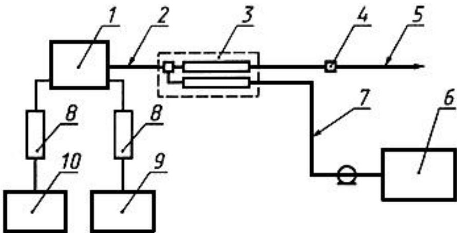
1 - испытуемое устройство; 2 - провод, в котором проводится измерение мощности радиопомех;
