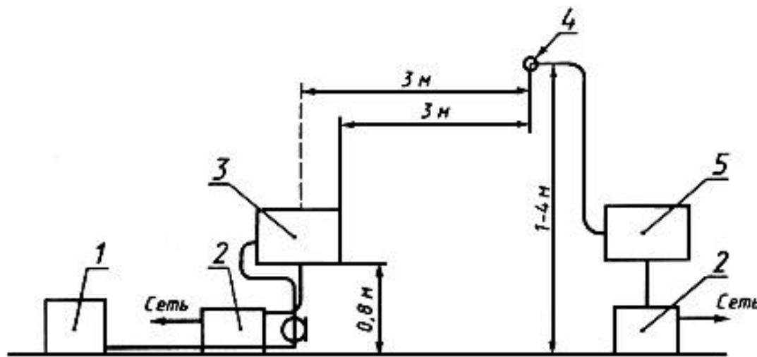
1 - генератор испытательных сигналов; 2 - помехоподавляющий фильтр;
