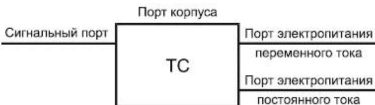
Рисунок 1 - Примеры портов ТС
