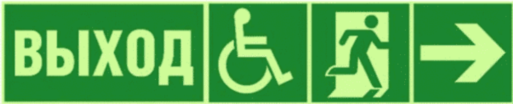
Рисунок 5 - Пример комбинации эвакуационных знаков
