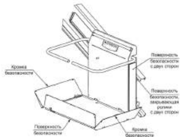
Рисунок 6 — Пример расположения кромки и поверхностей безопасности
