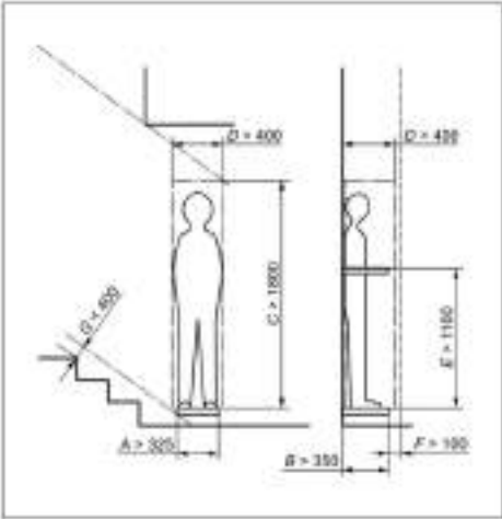
в) Платформа, установленная для ограниченного доступа для перевозки пассажира в положении стоя
