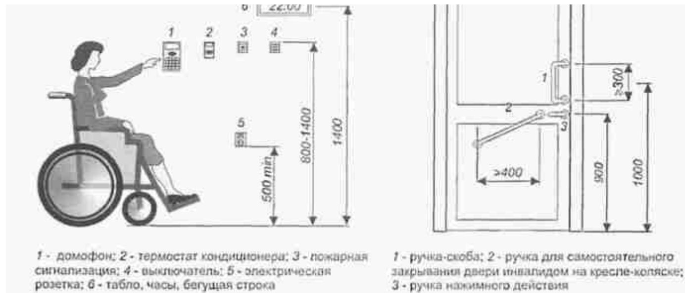
Рисунок Г.6 - Досыгаемость оборудования
