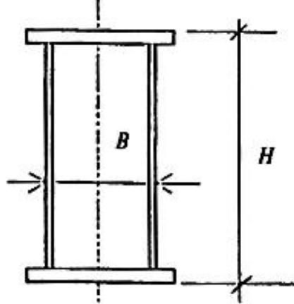
отклонение по высоте стоек и колонн, монтируемых в один и два яруса  $H$
