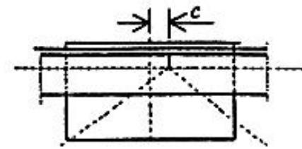
9. Смещение ребер и диафрагм жесткости при передаче сосредоточенных нагрузок в траверсах колонн, опорных узлах балок, рамных узлах и т.п. (толщина ребра -  $t_p$ )
